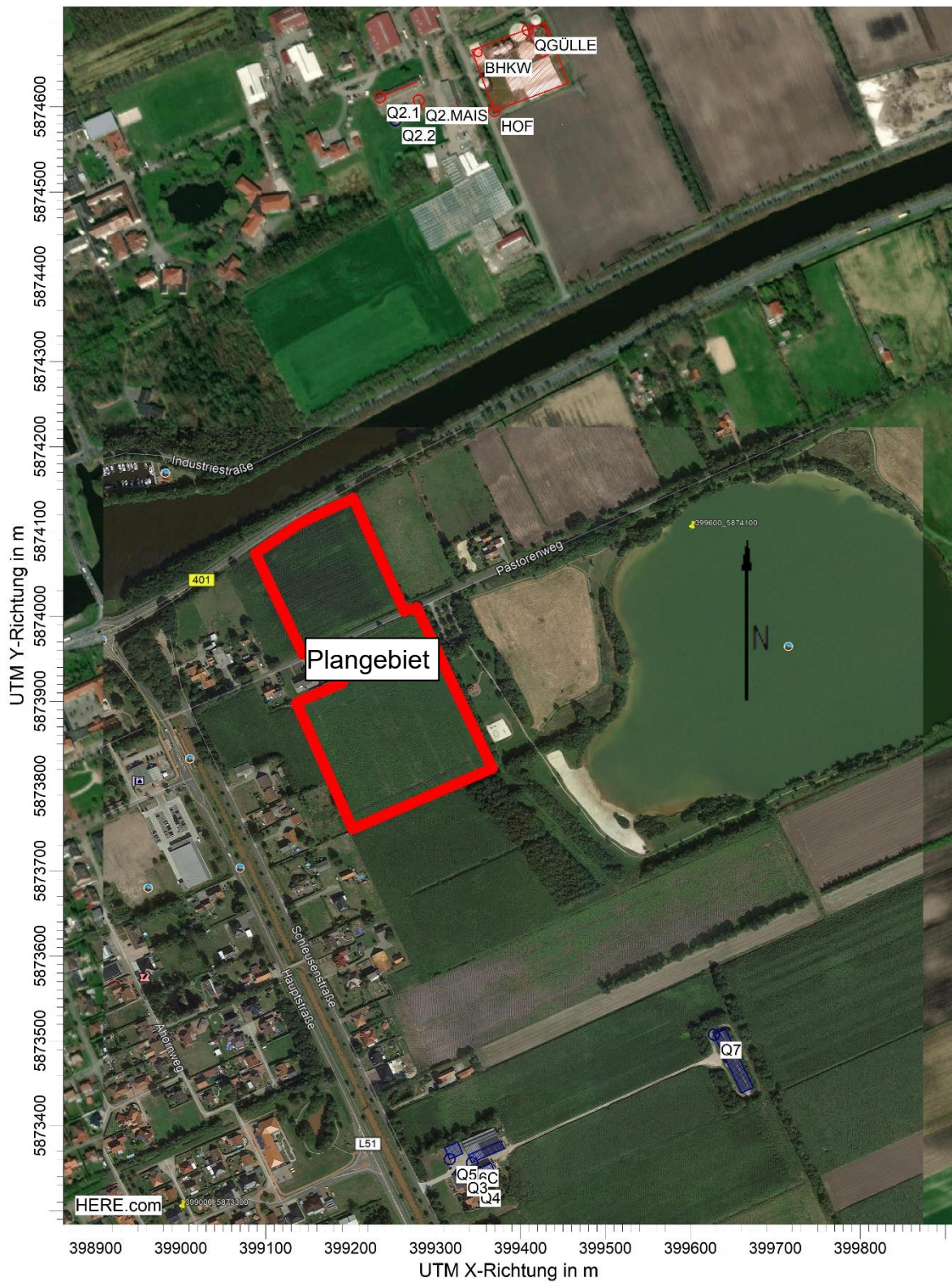
Abbildung 1: Lageplan Q...= Geruchsquellen Plangebiet (schematisch)
