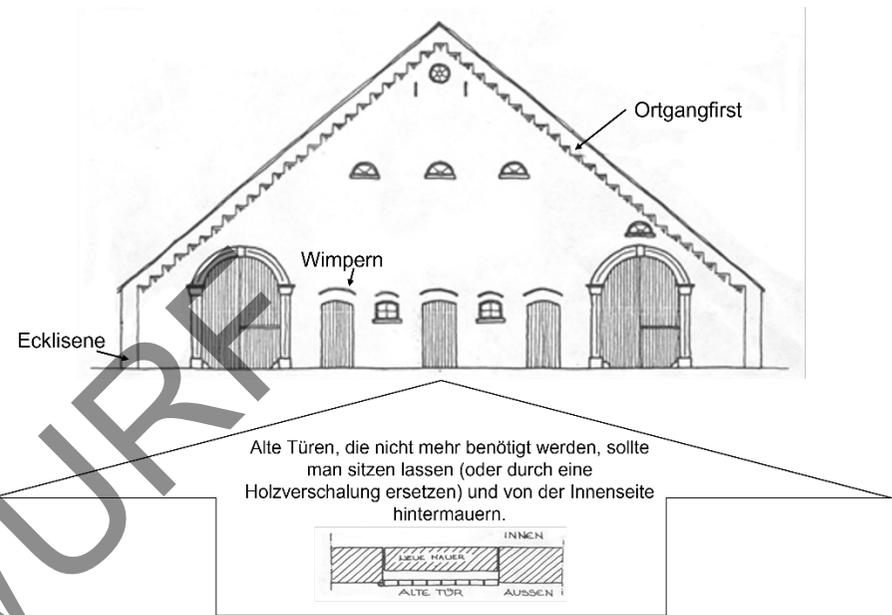
Alte Türen, die nicht mehr benötigt werden, sollte man sitzen lassen (oder durch eine Holzverschalung ersetzen) und von der Innenseite hintermauern.
