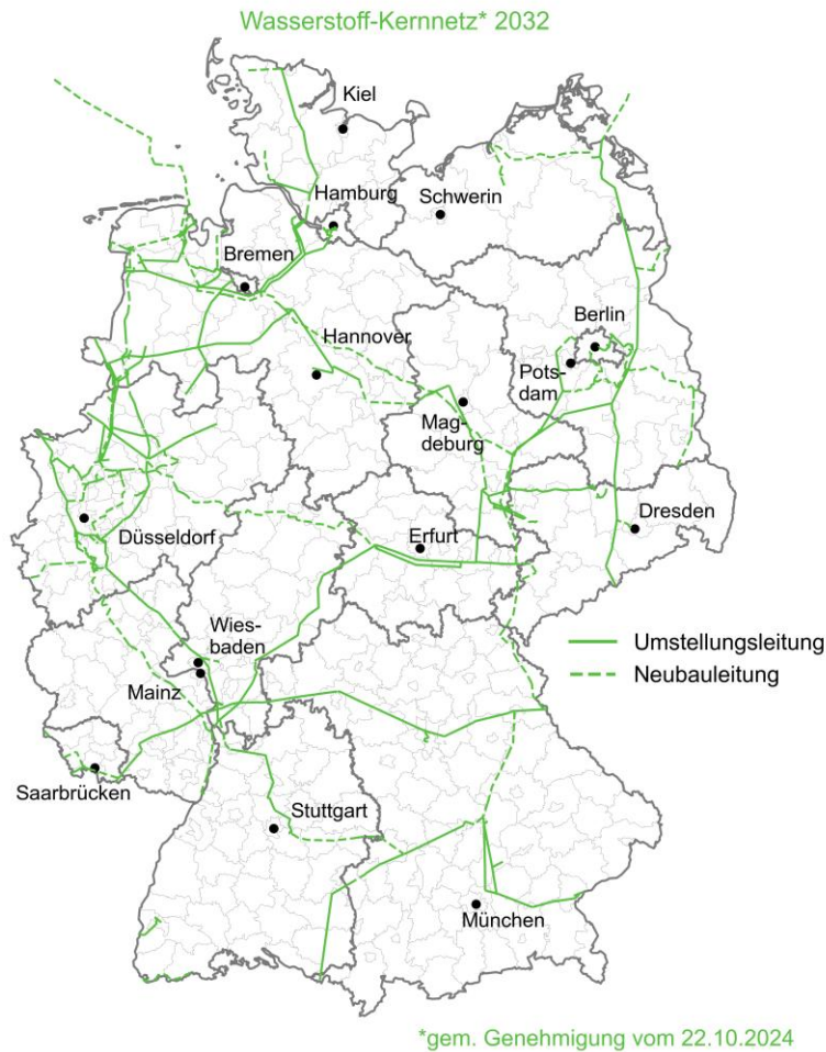
Abbildung 35: Übersicht Wasserstoffkernnetz in Deutschland
